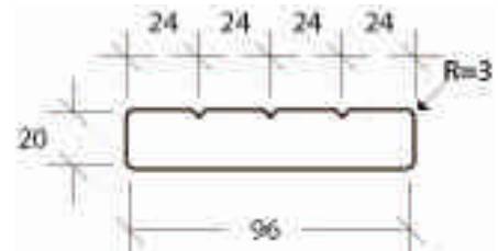
Lame rainurée 3V 20 x 96 mm
