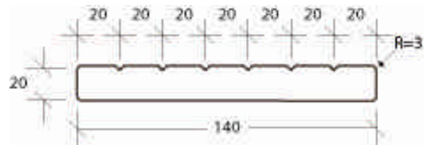
Lame rainurée 6V 20 x 140 mm
